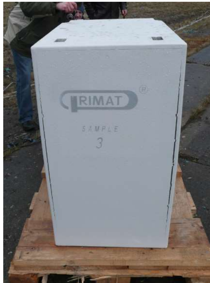
V hrbtu sta nastali razpoki
