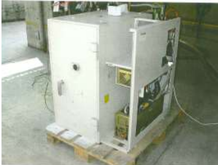
Primer bančnega avtomata z zaznavo eksplozivnega plina in dovodom inertnega plina
