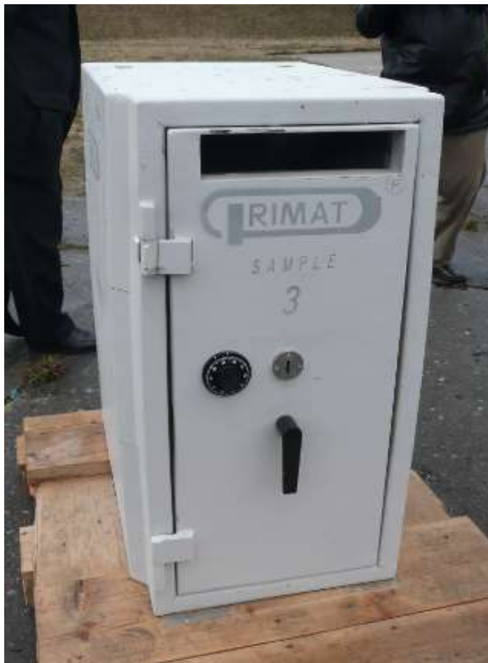
Pri eksploziji plina sta se reži med levo in desno stranico ter vrati povečali
